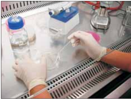
Trockene Staubprobe auf Nährboden ausgestrichen im Labor der BAM (Foto: Sabine Kacunko in der BAM)
