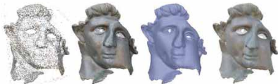
Zustandsmodell des Gesichtes. Von links nach rechts: grobe Punktwolke für die Bildorientierung und Kamerakalibrierung, dichte Punktwolke, vermaschte Punktwolke und texturierte Dreiecksvermaschung (Foto: Th. Kersten/DAI)
