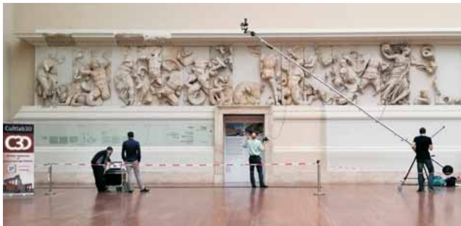
Photogrammetrisches Erfassen des Pergamonaltars (Foto: Fraunhofer IGD)
