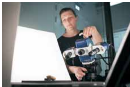
Eine Mitarbeiterin des ZEDIKUM digitalisiert eine Tontafel mithilfe eines Streifenlichtscanners. (Foto: SPK/photothek.net/Thomas Imo)
