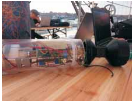
Zusammenstellen eines Roboters zur Erforschung der Wasserschadstoffe während eines subCULTron-Workshops in Venedig (Foto: UNIZG-FER, Croatia for the EU FET-PROACTIVE H2020 project subCULTron)
