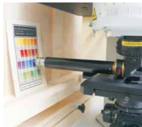
Raman-Mikroskopie in situ an einer historischen Farbmusterkarte (Foto: Doerner Institut)
